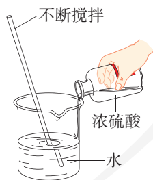
图 3-5 浓硫酸稀释的正确操作
