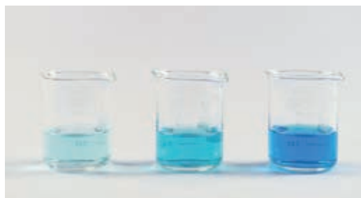
图2-18 三种浓稀不同的硫酸铜溶液
