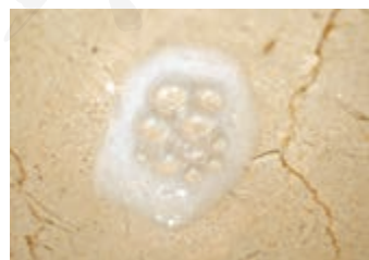
图4-3 盐酸腐蚀含碳酸钙的建材
