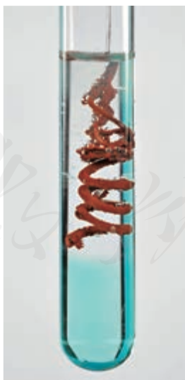
图1-13 铝与硫酸铜溶液的反应
