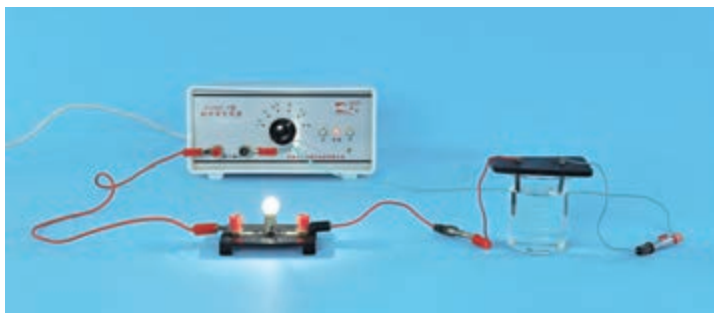
图3-9 试验物质的导电性
