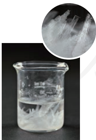
图2-10 冷却热的饱和溶液时，硝酸钾晶体从溶液中析出
